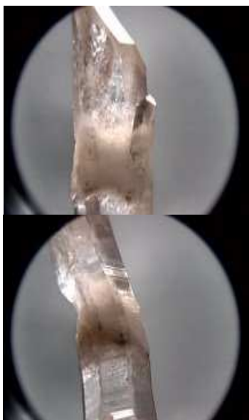
fig. 30 : cristal de quartz coudé thermiquement et mécaniquement
