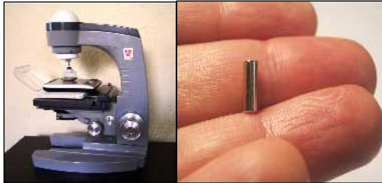
Figure 79 : balance hoover et un minuscule aimant au néodyme 1/8 de 3mm de diamètre appliqué aux gemmes pour mesurer la susceptibilité magnétique par l'intermédiaire d'une balance Hoover
