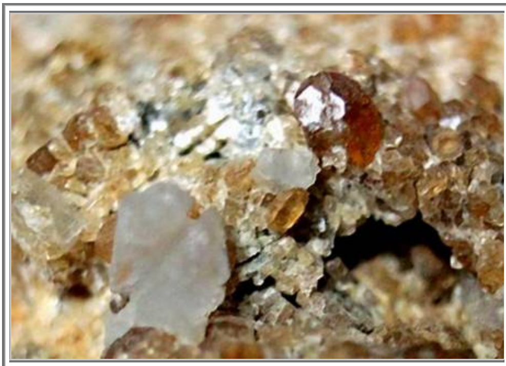
Figure 40 : Skarn : Barèges : Pic d'Eras-Lids : Grenats rouges Grossulaire-Andradite La transformation des résultats des analyses massiques en quantités molaires, conduit à une composition 66% grossulaire – 34% andradite
